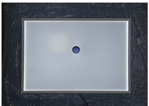
導光板の穴加工 検査用光源 特注仕様
